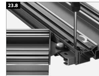
De connector 90° wordt dmv de klemstukken vastgezet.
